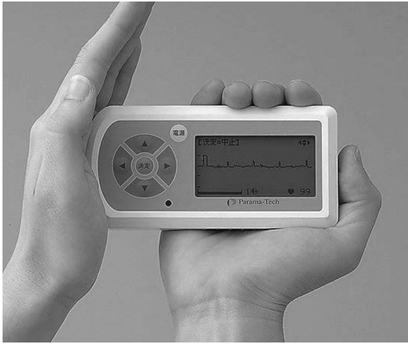
図 1. 携帯型心電計による RR 間隔の測定
